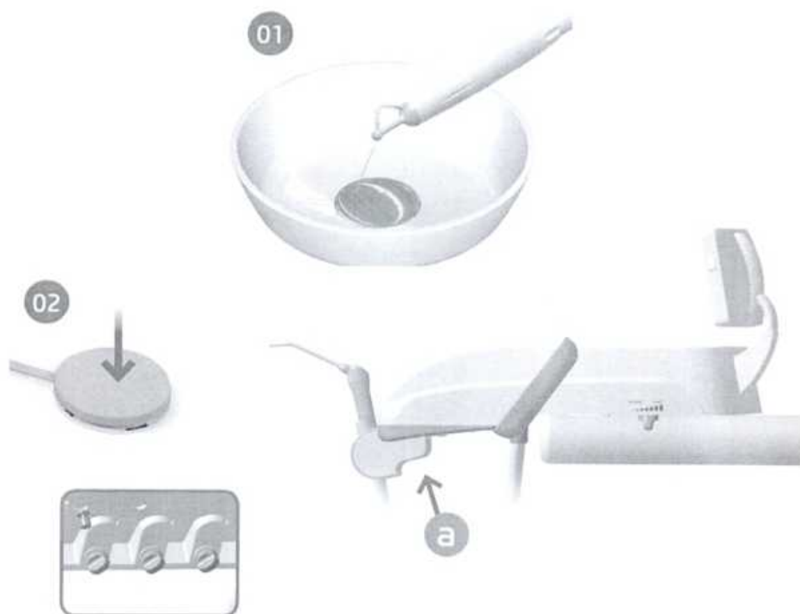
a Registro de água
